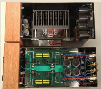
Interno e circuitazione del preamplificatore Essenza e di uno dei due finali MsE 02. Costruzione artigianale sebbene molto raffinata.
